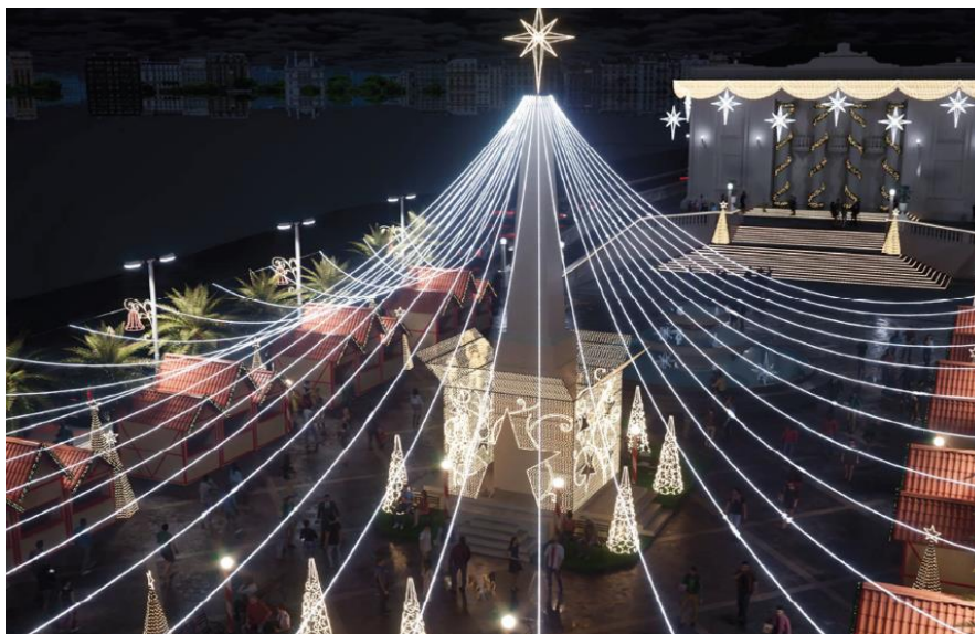
Revestimento em tela metálica pintureiro fio 240 bwg. Preenchido de cordão de led em seu aro interior (espaçamento 10cm).
