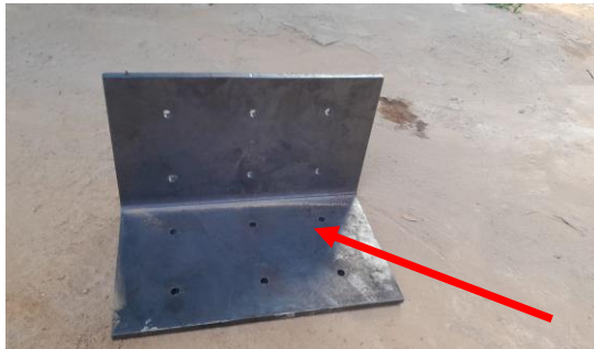
Imagem 42 Chapa de aço reforço
