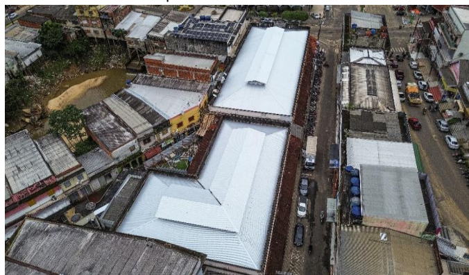
Imagem 11 TELHAMENTO COM TELHA DE AÇO/ALUMÍNIO E = 0,5 MM, COM ATÉ 2 ÁGUAS, INCLUSO IÇAMENTO. AF_07/2019
